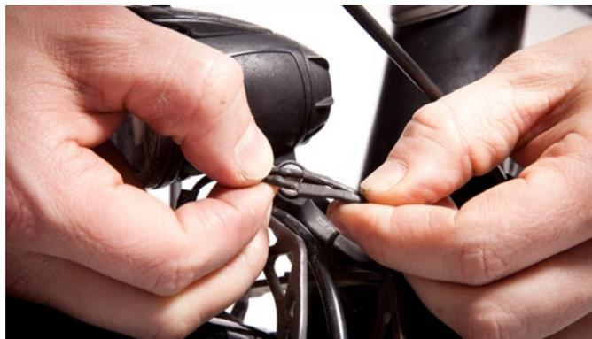
Offenliegende Lichtkabel sind verletzlich, daher gelegentlich den Zustand der Kabel und Verbindungen prüfen, bevor die Lichtenanlage ausfällt.
